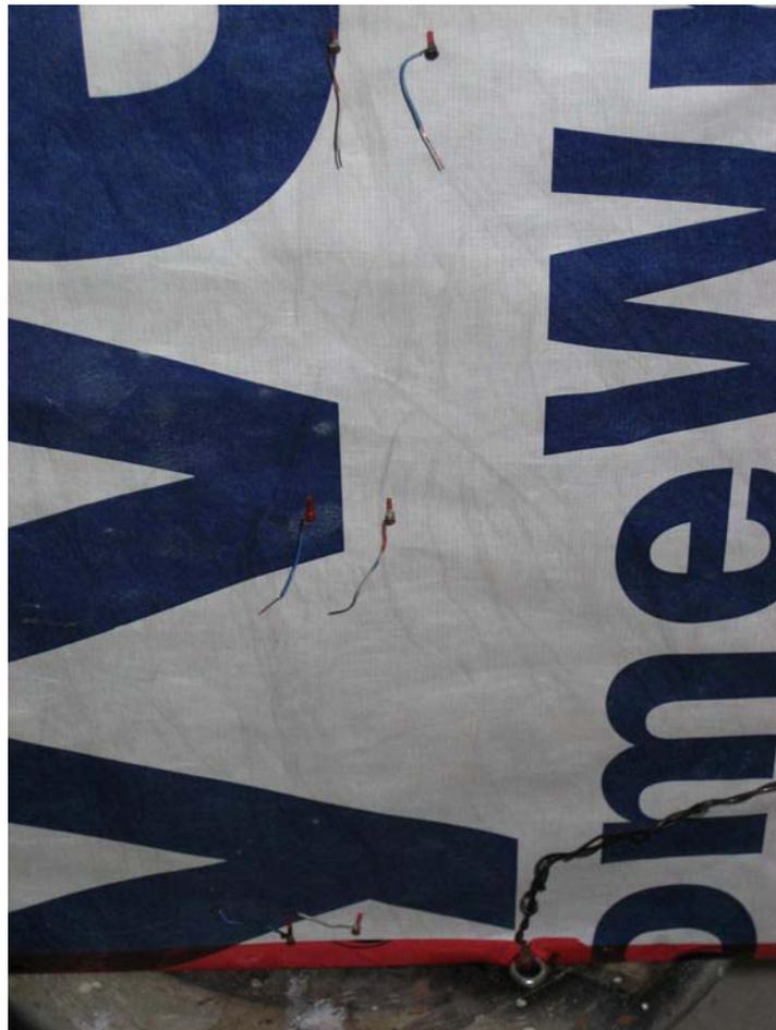
Schéma 3.5 : Trois épingles installées sur le panneau test d'OSB à travers le Tyvek.
